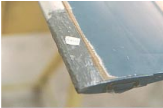
Tentativa de reparo de uma pá acidentada.
